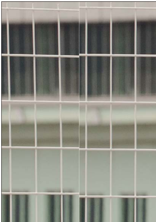
▲ Abbildung 9-80: Verzeichnung äußert sich in verbogenen Kanten, vor allem am Rand des Fotos.
